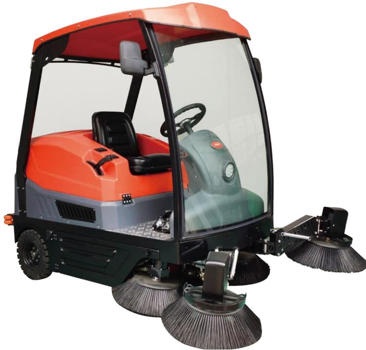
全新智能管理系統，具有超強吸力，清掃寬度1950mm，是一台大面積、高清掃效率的駕駛型掃地機，絕佳的操控性及安全性，使用年限長，適合多種區域及地面使用。
